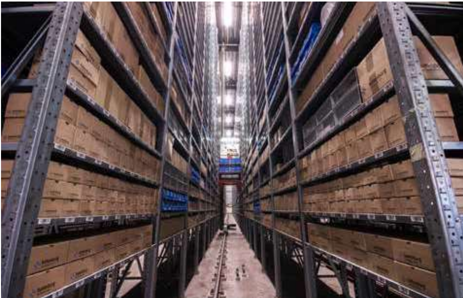
De oude magazijninrichting met drie gangpaden, bediend door een man-up truck. In de plaats kwam een opstelling rond twee pickingzones: één met vier en één met drie Modula-kasten van Vanas Engineering.
